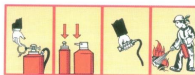
Приведение в действие воздушно-пенного огнетушителя
